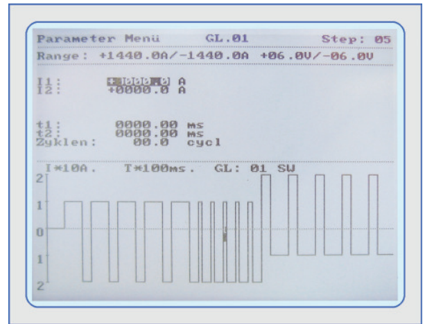
Sollwert-Programmierung mit grafischer Anzeige als Programmierhilfe
