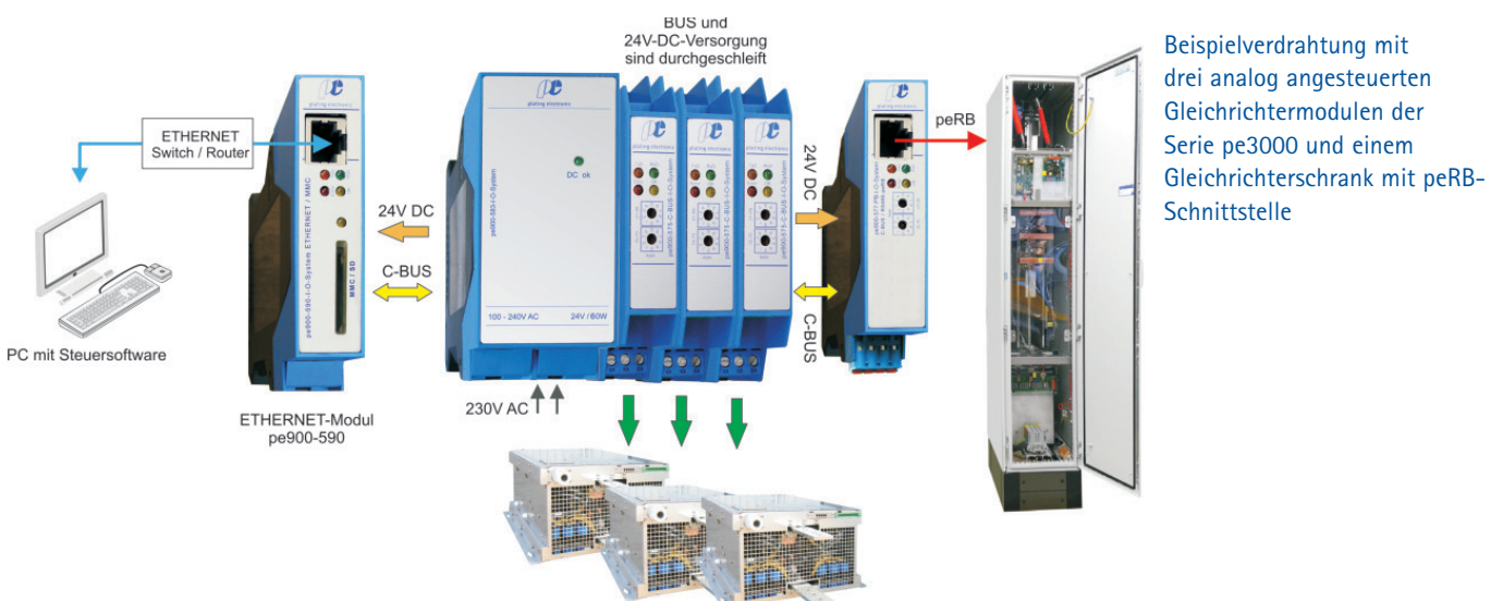
pe900-590, TCP/IP-Modul mit MMC/SD-Kartenleser
